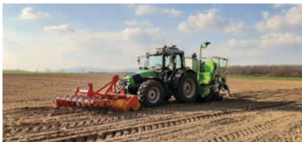
Sl. 12. Primena kombinovanog oruđa za predsetvenu pripremu i setvu sa GPS navođenjem (selekciona stanica KWS-a u Mađarskoj)
